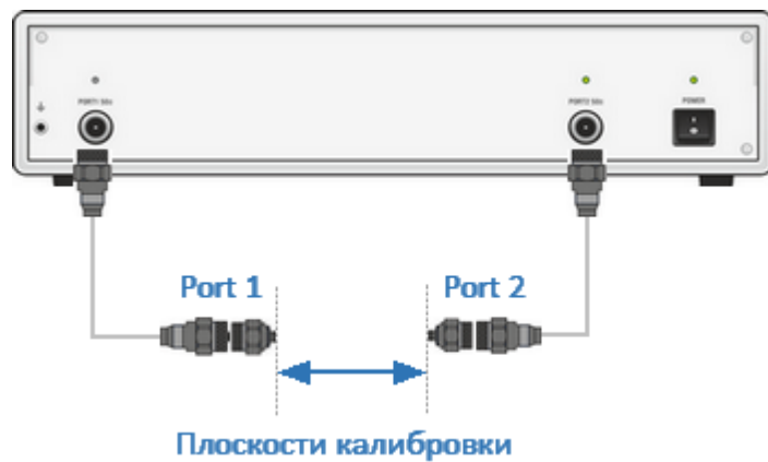
Рисунок 121 – Пример плоскостей калибровки
