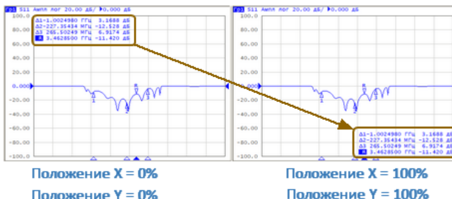
Рисунок 177 – Расположение индикации данных маркеров на экране
