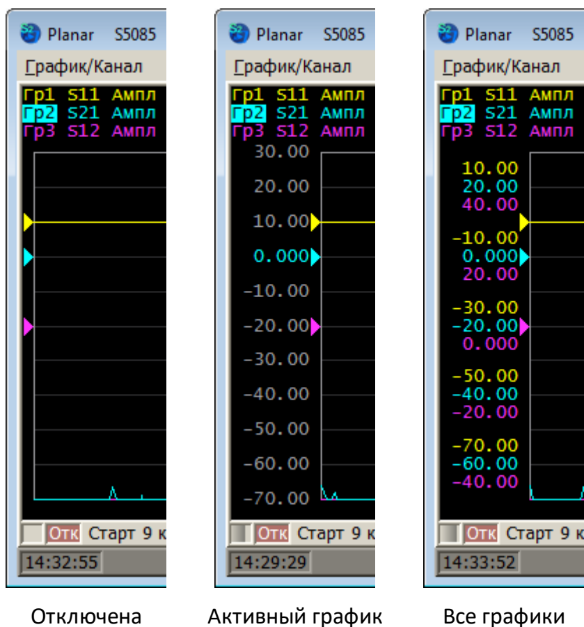
Рисунок 273 – Оцифровка вертикальной оси
