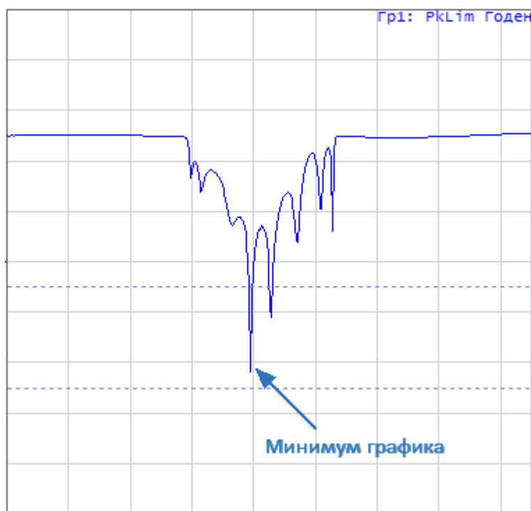
Рисунок 206 – Пример пройденного теста (Тип предела: "Отклик")
