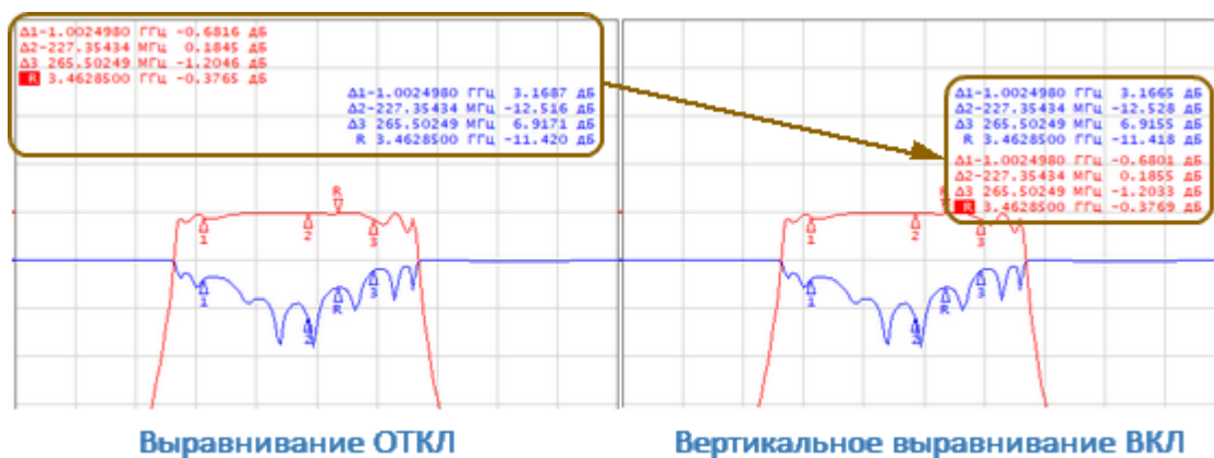
Рисунок 178 – Пример выравнивания положения индикации данных маркеров
