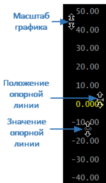
Рисунок 84 — Настройка параметров на вертикальной оси измеряемых значений
